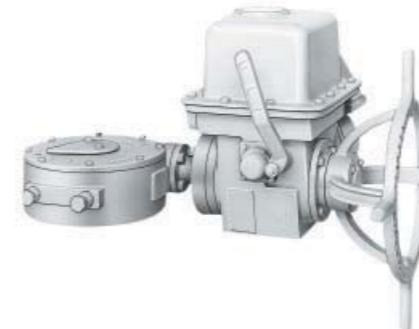
标准电源为200V,400V三相电源，主要应用在350mm以上的阀门。除开关控制外，配置电控位置控制器，可实现在直线流量比例控制功能。
